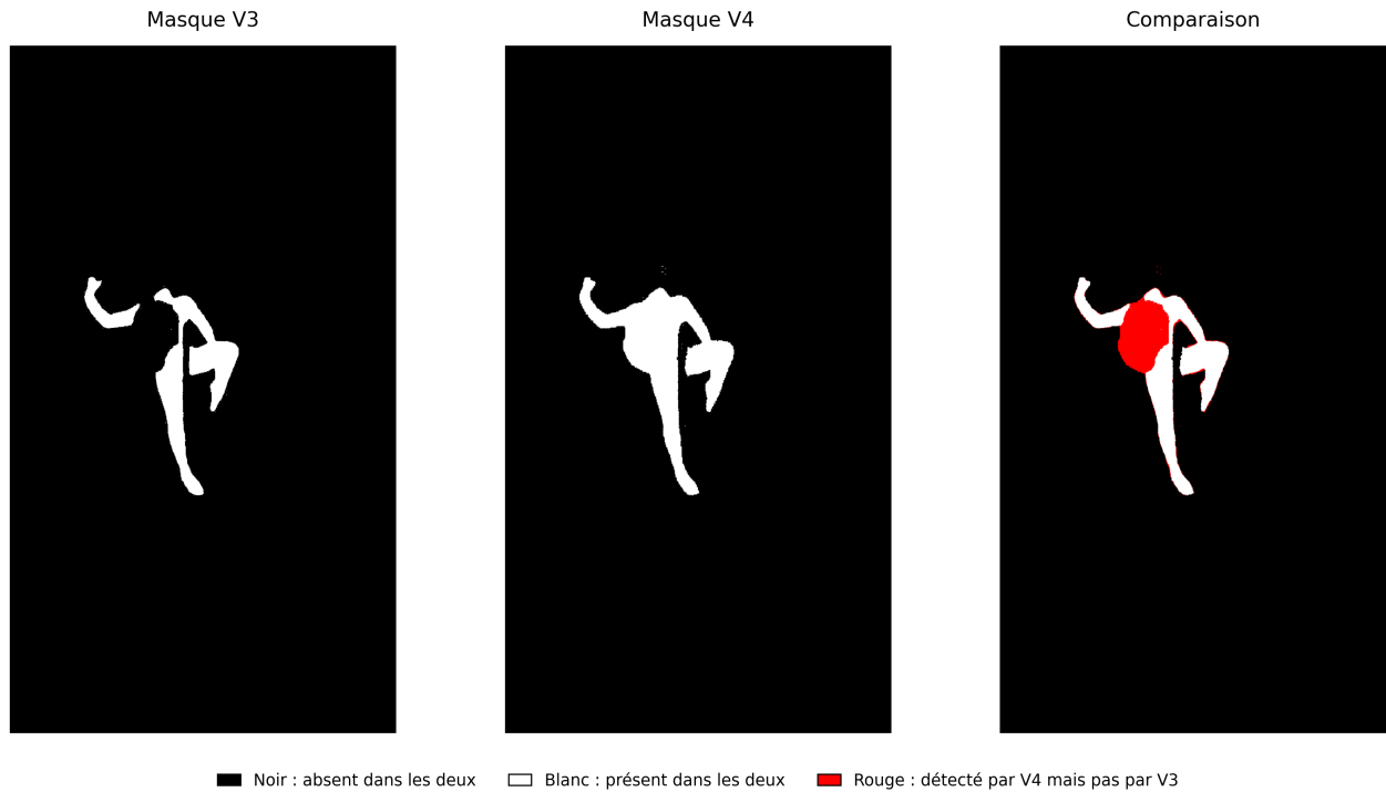
Figure 10 – Comparaison locale des masques obtenus sur la frame 391. Les zones blanches sont détectées par les deux pipelines, tandis que les zones rouges correspondent aux régions segmentées par la V4 mais non détectées par la V3.
